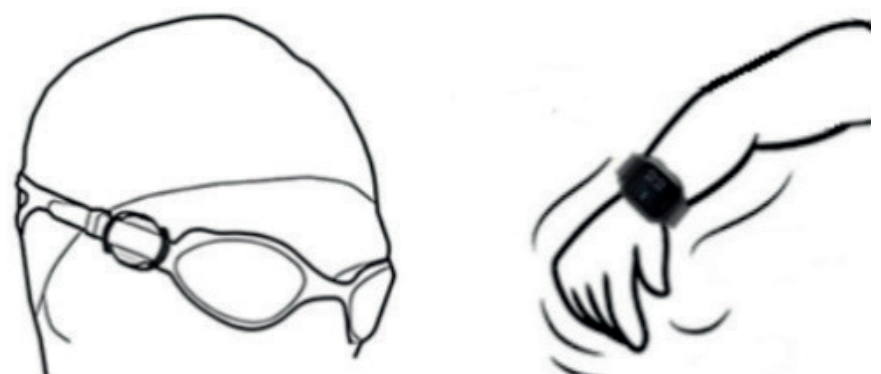
Figura 4. Sensore ottico alla tempia per la misura della frequenza cardiaca nel nuoto
