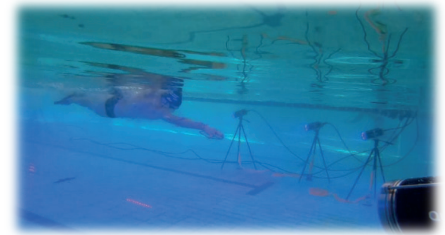
Figura 6. Nuotatore impegnato nei test per valutare l'effetto dei "swimming tools" con un sistema di Underwater Motion Capture e un pacer luminoso.
