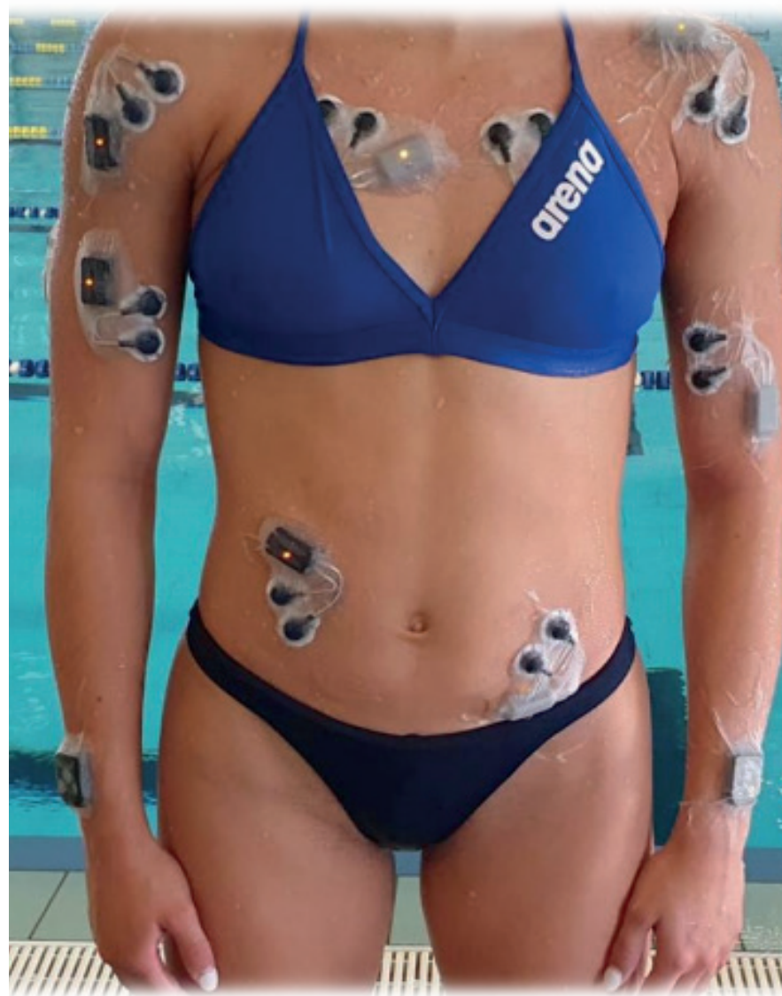
Figura 1. Set up e posizionamento s-EMG e sensori inerziali.
