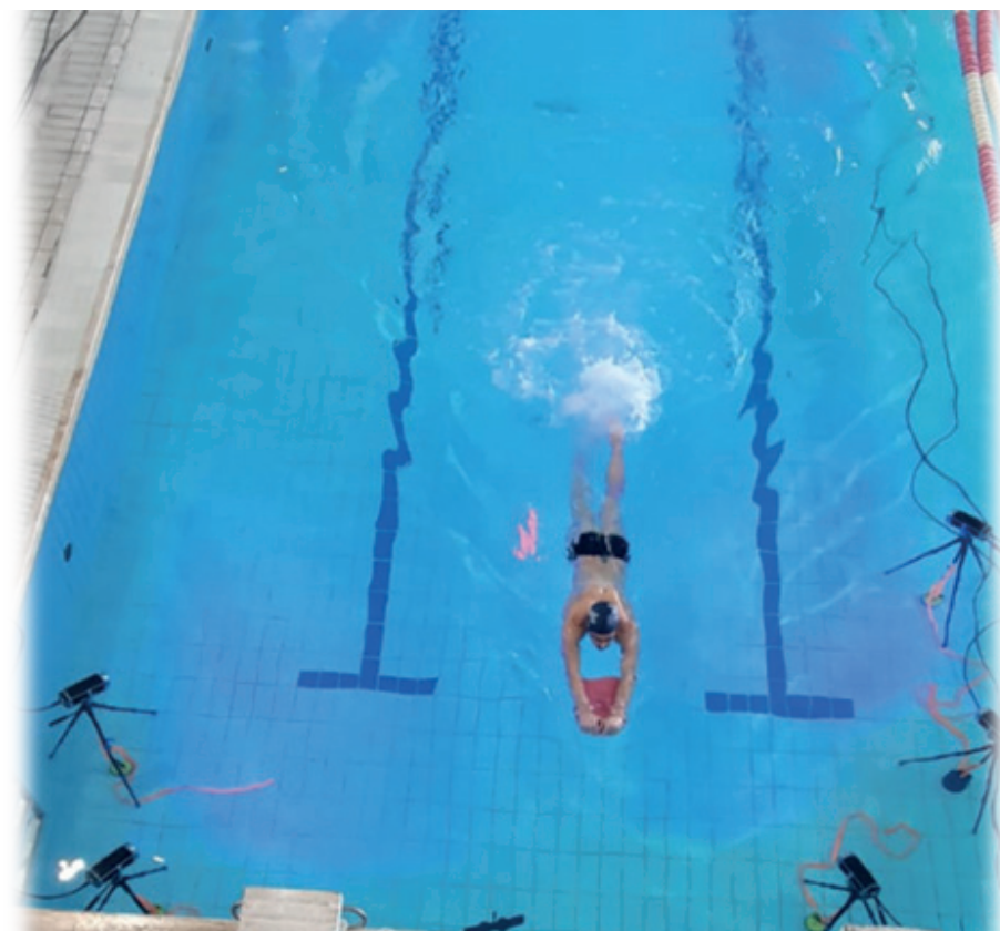
Figura 8. Nuotatore durante una prova nella condizione "gambe tavoletta" misurato con analisi del movimento tridimensionale.
