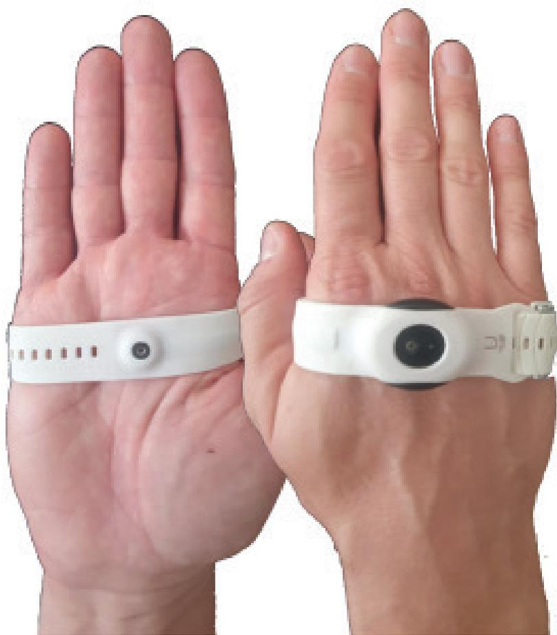
Figura 1: Modello di sensori di pressione indossabili per l'analisi della propulsione in acqua
